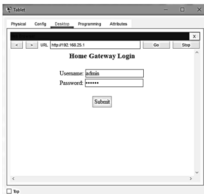
Рисунок 3. Веб-сервер на основном шлюзе: а) ввод IP-адреса и регистрация на основном шлюзе; б) веб-браузер на основном шлюзе (Main Gateway)
